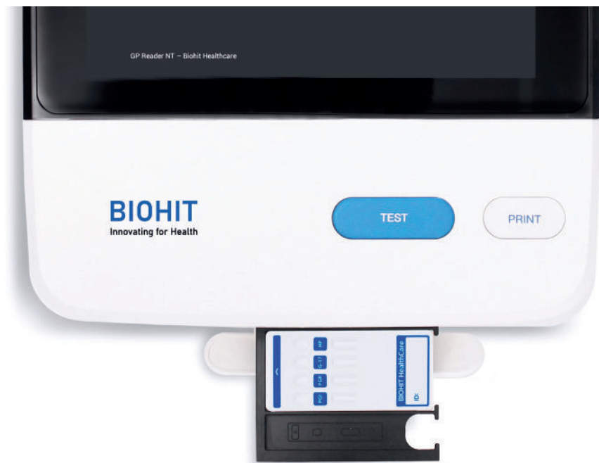
Abbildung 11. Richtige Ausrichtung der Testkassette im Kassettenfach.
