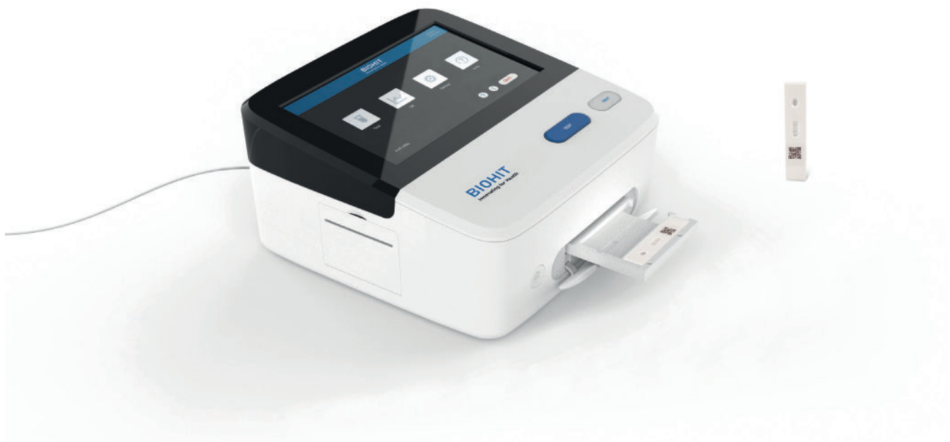
Figura 4.12. Inserimento della scheda di prova QC nel vassoio della cassetta.
