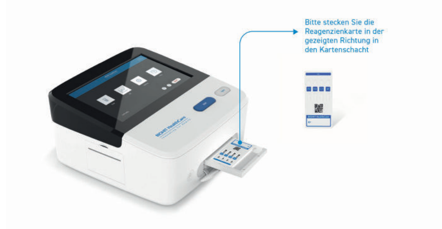
Abbildung 4.12. Einsetzen der QK-Testkarte in das Kassettenfach
