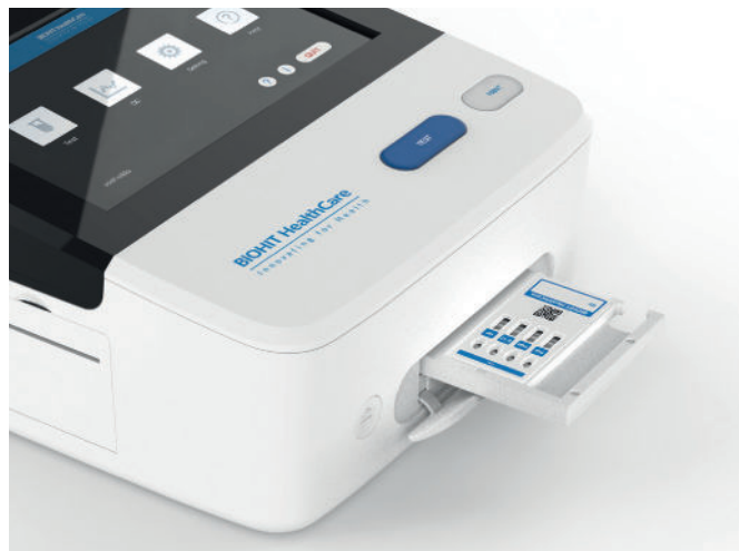
Abbildung 4.5. Die Testkassette wird wie hier dargestellt in das Kassettenfach eingelegt
