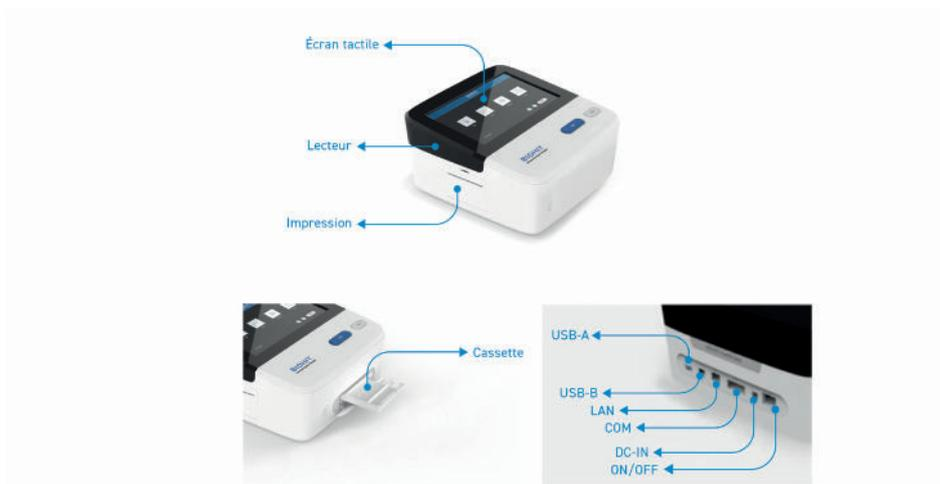
**Figure 2.3.** Principales fonctions de l'appareil
