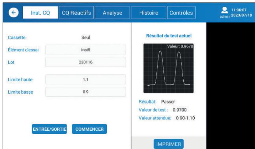
Figure 4.11. Écran de contrôle de qualité de l'appareil (Inst. QC).
