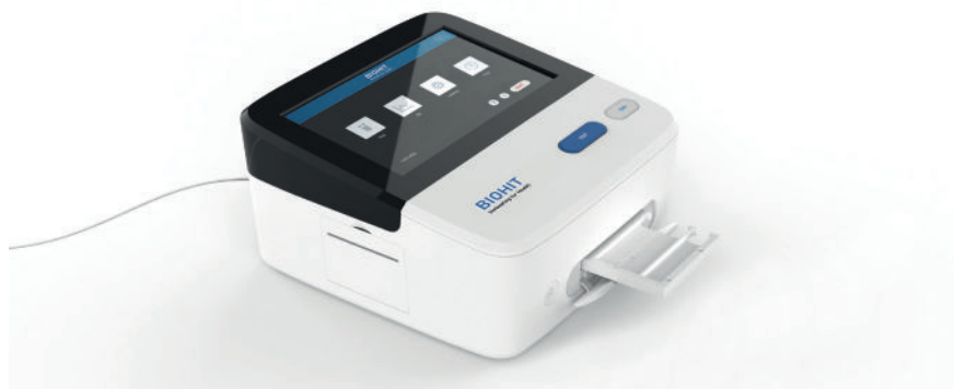
Abbildung 3.1. Das Messgerät ist einsatzbereit; das Kassettenfach ist geöffnet, so dass die Kassette eingesetzt werden kann.
