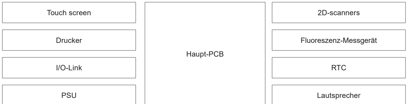
Abbildung 2.1. Beschreibung der Hardware – Integrierter Drucker mit I/O-Link, Summer und Echtzeituhr, Touchscreen, Drucker, 2D-Barcode-Sanner, Fluoreszenz-Messgerät (opto-elektromechanisch).
